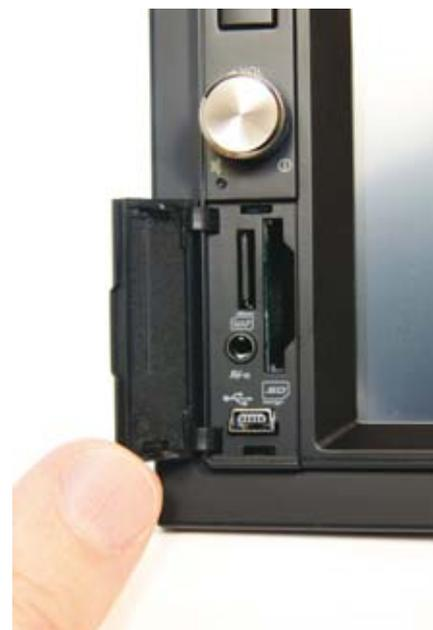
*Un particolare dell'interno dello sportellino con gli slot e le connessioni per ulteriori sorgenti. Lo slot microSD è occupato stabilmente dalla card con le mappe dell'unità di navigazione.*
