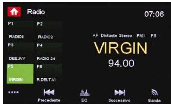
La schermata relativa alla sezione FM è completa, ad eccezione della funzione radio-text. Le sei prese sono immediatamente richiamabili.
